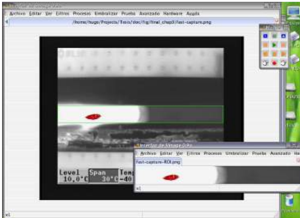
Figura 3.12: Captura de pantalla de la SImageGUI con imagen adquirida desde el magnetoscopio y, simultáneamente, con la ROI recortada según la selección del usuario en la primera.
