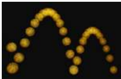
Figura 1.6: Ejemplo de streak photography : trayectoria debida a los choques semielásticos de un objeto en el campo de visión de una cámara estándar; imagen obtenida por la técnica de estroboscopia.
